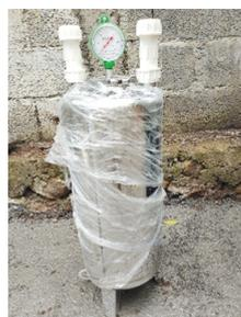
Eliminer les impuretés contenues dans le biogaz. L'eau, par saturation, l'hydroxyde de soufre, le dioxygène, et d'autres gaz rares. Le groupe électrogène est donc protégé de la rouille, et d'autres impuretés
